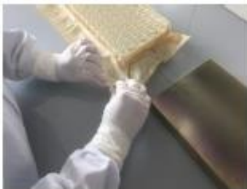
Déchirer la largeur droite de la poche – Tear the right side of the bag
