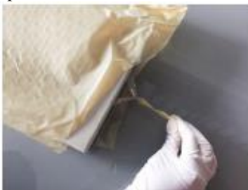
Faire ressortir la languette qui maintient les flacons par la fenêtre de l'outil de transfert – Pull out the strip which maintains vials through the window of the transfer tool.
