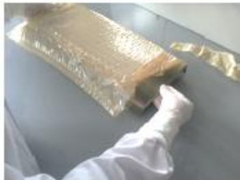
Insérer l'outil de transfert avec précaution fond vers le haut – Insert transfer tool with bottom upward
